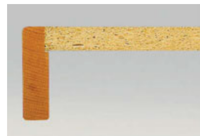
Sezione del piano tavolo con il bordo piatto di altezza mm. 70 e spessore mm. 10 di faggio naturale Section of table top with flat edge 70mm high and 10mm thick in natural beechwood
